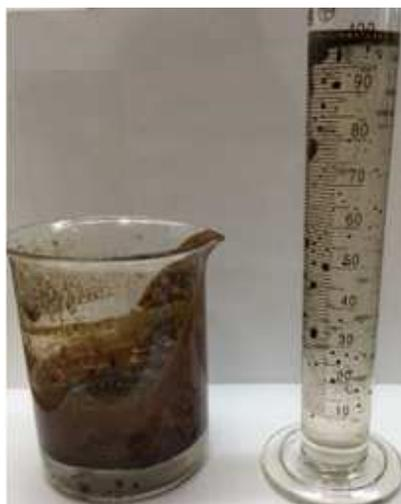
Рис. 2. Разделение фаз водонефтяной эмульсии скважины
